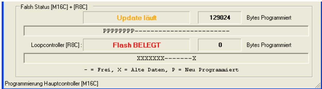
Während des Updates wird im unteren Fensterbereich eine Statusanzeige eingeblendet, die der Anzeige im Display der Zentrale ähnelt. Diese zeigt den Status der einzelnen Flashblöcke und die Anzahl der bereits programmierten Bytes.
