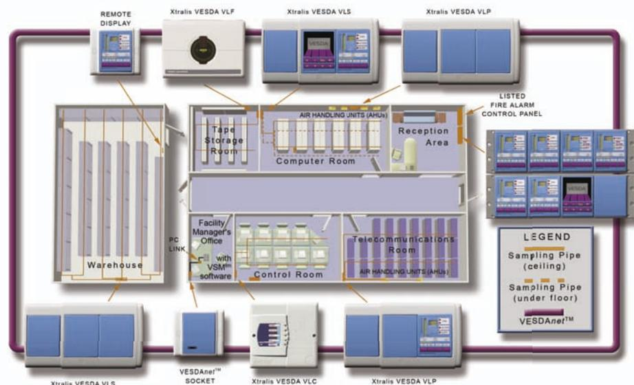
Wenn sich alle VESDA Rauchdetektoren in einem VESDAnet Netzwerk befinden, können Sie jeden Detektor von einem zentralen Standpunkt aus, in diesem Fall das Büro des Anlagenleiters, konfigurieren und abfragen.
