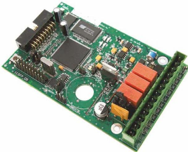
Die Xtralis VESDA VLF MCC (Multifunktions-Kontrollkarte) ist eine Schnittstellenkarte für Rauchansaugmelder der Serie Xtralis VESDA VLF. Mit einer MCC wird der Umfang der von einem VLF verwaltbaren eingehenden und ausgehenden Kontakten erweitert.
