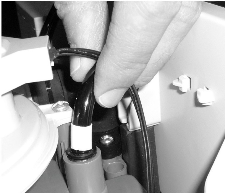
Abbildung 7-16: Kurzen Schlauch einschieben
