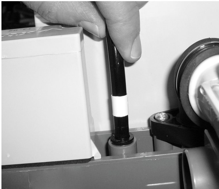
Abbildung 7-17: Langer Schlauch einschieben
