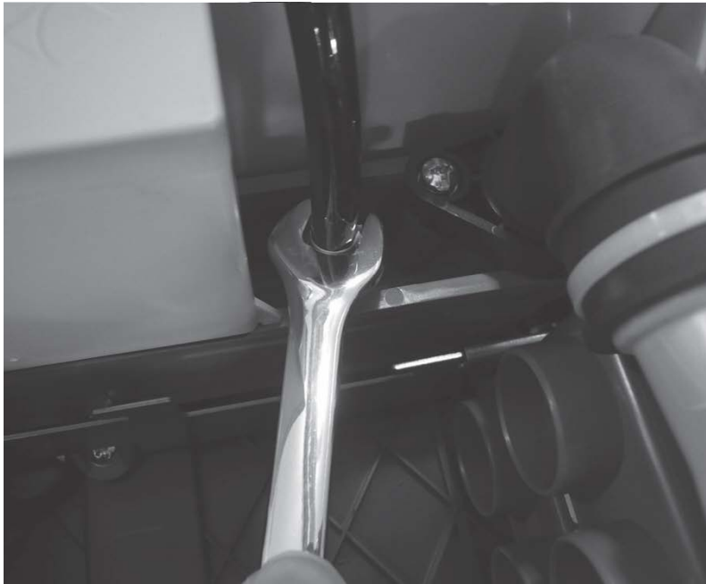
Abbildung 7-9: Langen Schlauch abziehen
