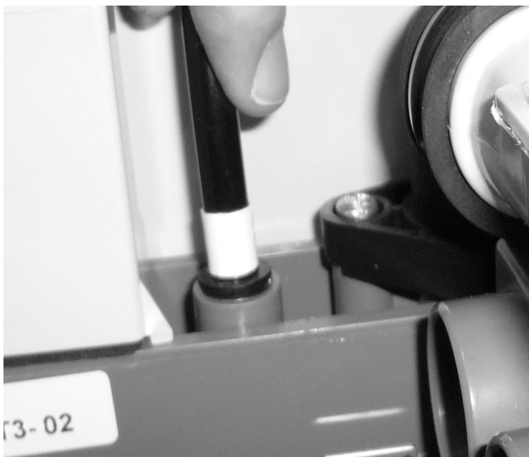
Abbildung 7-18: Langer Schlauch vollständig einschieben
