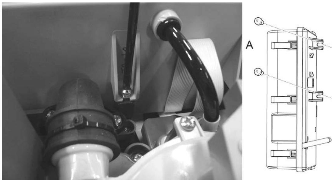
Abbildung 7-8: Halteschrauben der Kammer entfernen
